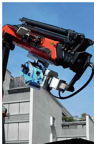
Aufnahmegert inklusive Pendelbremse und einer Kran-Funkwaage.
