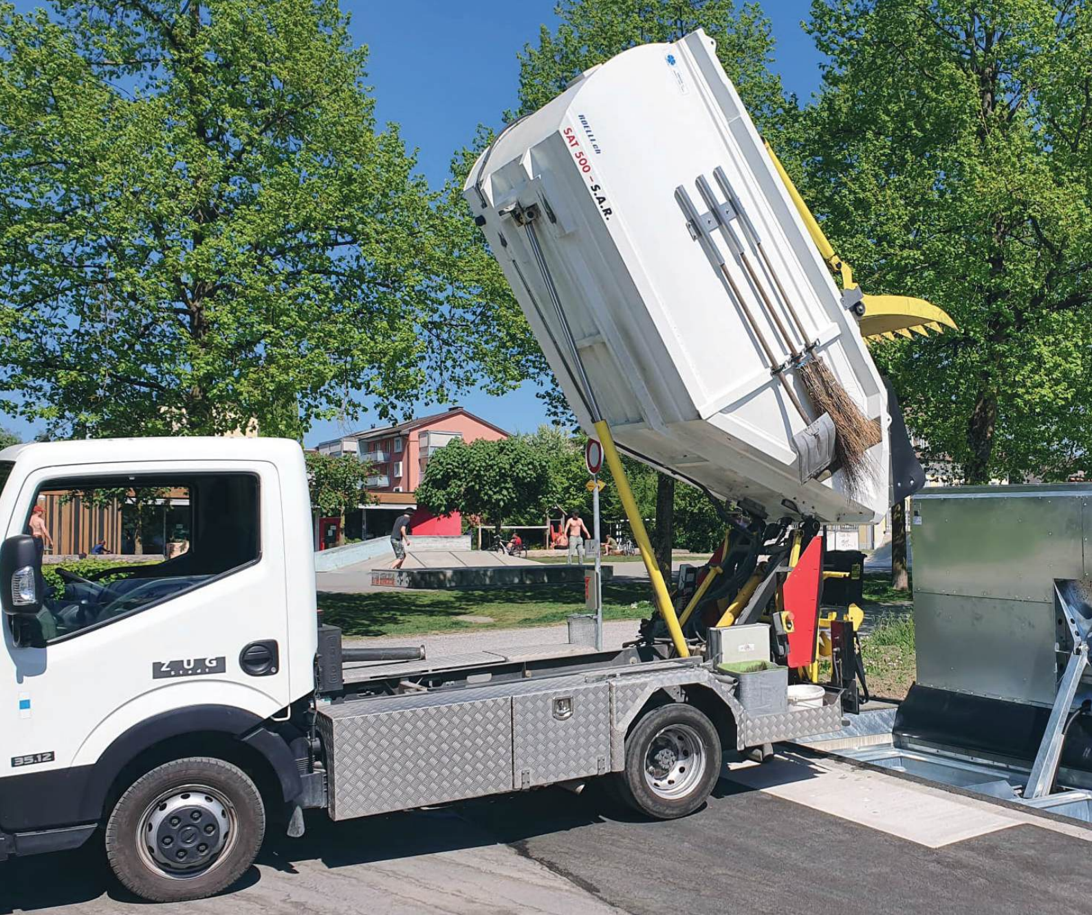
Plattform mit hydraulischer Öffnung und Schliessung.
