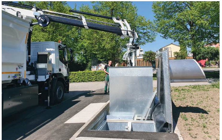
Entleerung des Stahlcontainers mit Inhalt 6 m 3 durch den Speed-Waste-Lifter.
