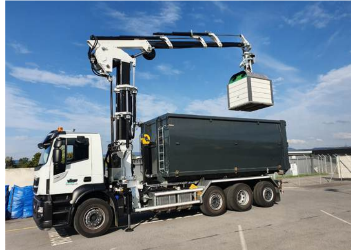
Positionen über der offenen Mulde programmierbar
