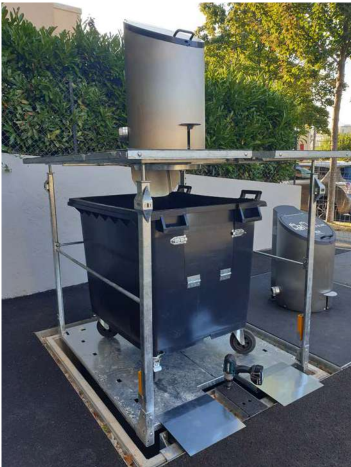
LU 150-L mit Baléro-Säule 120 für die Entnahme des Containers hochfahren.
