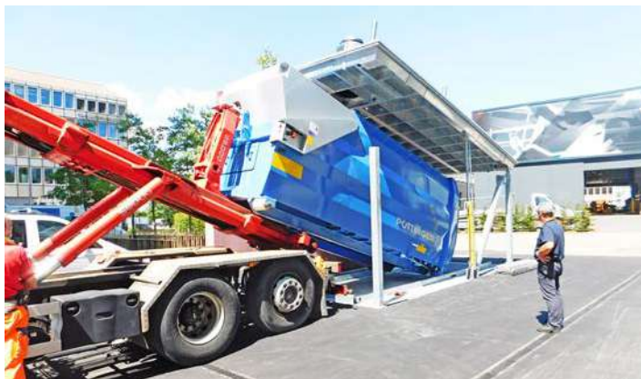
Einwurfsäule vorne vom Liftsystem. Der Container kann direkt geladen und entleert werden.
