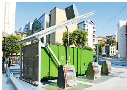
Kartonsammlung mit einem Quadromat 650-31. Steinplattform mit Gefälle, dem Gelände angepasst. Drei Untergrund-Container Sub-Vil für Restabfälle.
