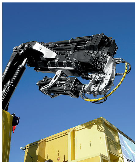
Kran mit Speed-Gripper und Umklappvorrichtung.
