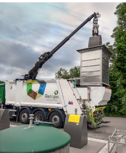
Containerentleerung mittels Dachkran mit Speed-Gripper.
