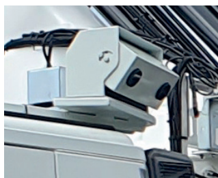
Beidseitig installierte Stereokamera auf LKW-Kabine.
