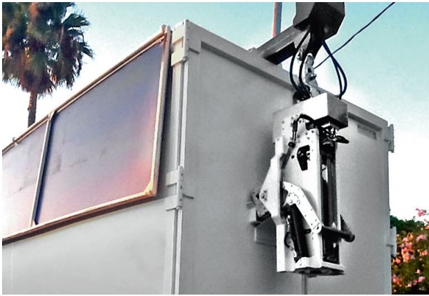
Stationnement arrière, console de stationnement de type VPH 028.
