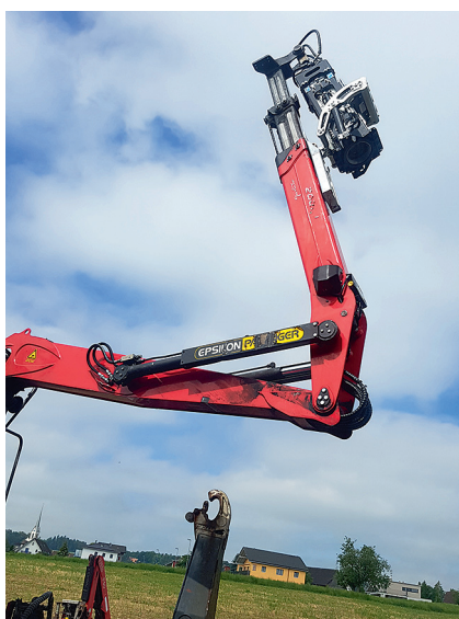
Mettez le bras télescopique en position verticale et placez-le dans la console.
