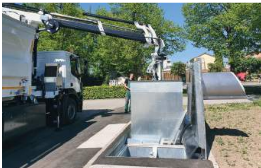
Vidange du conteneur en acier d'une capacité de 6 m 3 par un Speed-Waste-Lifter.
