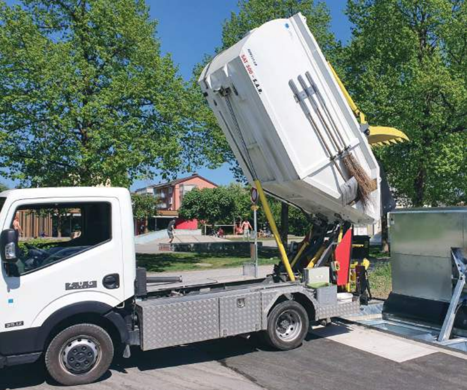
Plateforme avec ouverture et fermeture hydrauliques.
