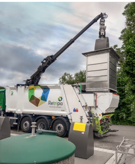
Vidange de conteneur à l'aide d'une grue en toit avec Speed-Gripper.
