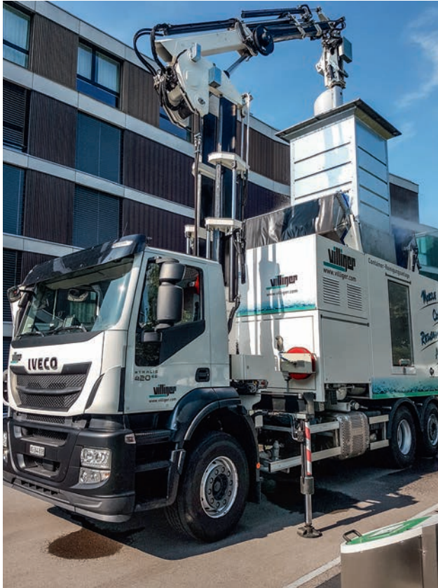
Lavage automatique d'un conteneur souterrain dans le module de lavage mobile.
