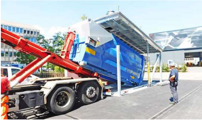
Colonne d'insertion à l'avant du système de levage. Le conteneur peut être directement chargé et vidé.
