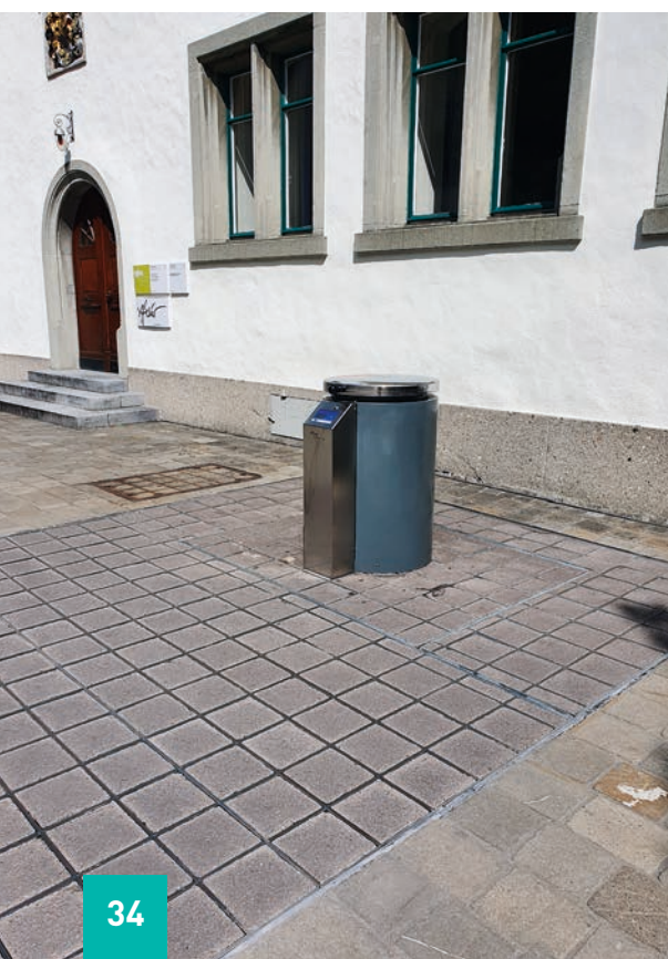
À gauche : colonne d'insertion de type Caslano avec système d'accès intégré et avec trappe de décharge. Plateforme à revêtement quadrillé en pierre.
