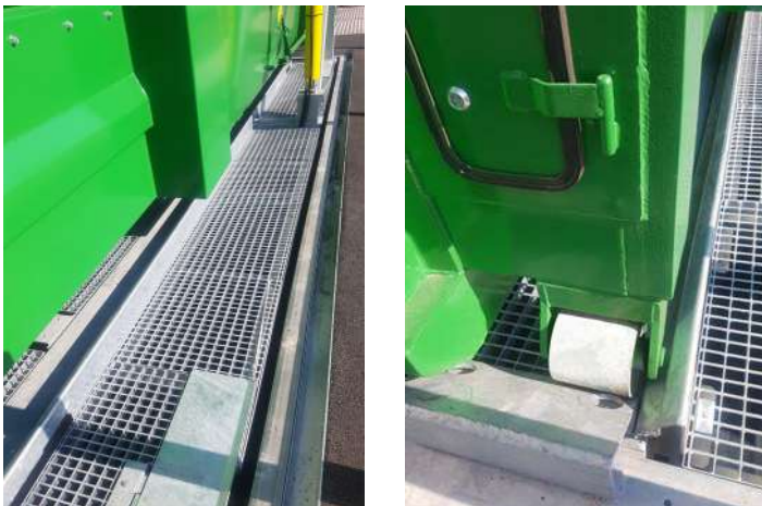
Rail de guidage pour le positionnement du conteneur compacteur.
