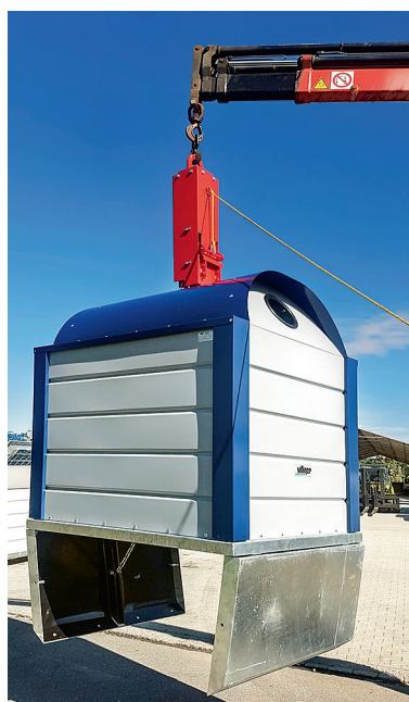
Movimentazione del contenitore con fondo sbloccato.
