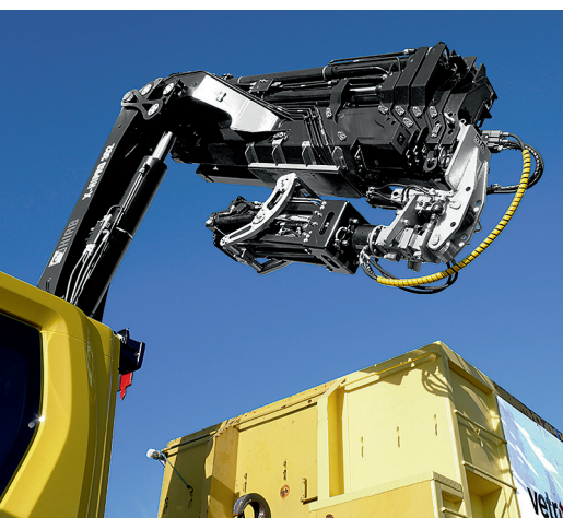
Dispositivo di presa con dinamometro radio. Dispositivo di svuotamento per contenitori con sistema di svuotamento a fungo VP 28 con dispositivo di ripiegamento idraulico e freno a pendolo. Dispositivo di ripiegamento tipo AFV 28.
