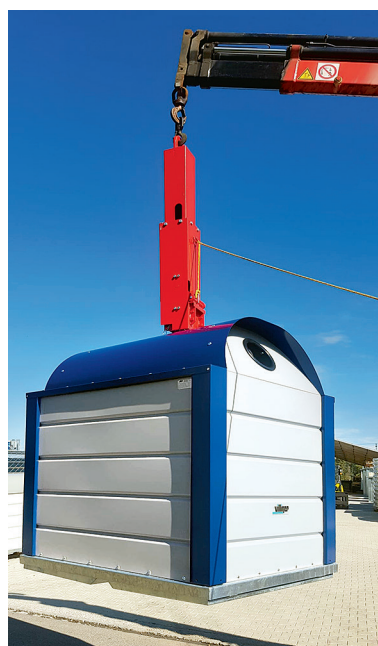
Sollevamento con fondo del contenitore chiuso e sicuro.
