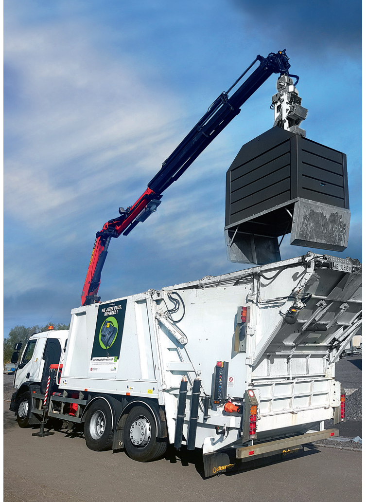
Il contenitore viene svuotato nella parte posteriore per mezzo di un dispositivo di ripiegamento incorporato tipo VP 128.
