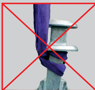
Movimentazione del contenitore con fondo sbloccato.
