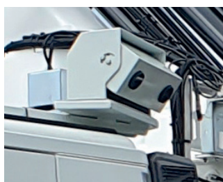
Telecamera stereo installata su entrambi i lati della cabina del camion.
