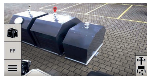
La selezione del contenitore corrispondente avviene tramite la schermata di selezione con il touch screen.
