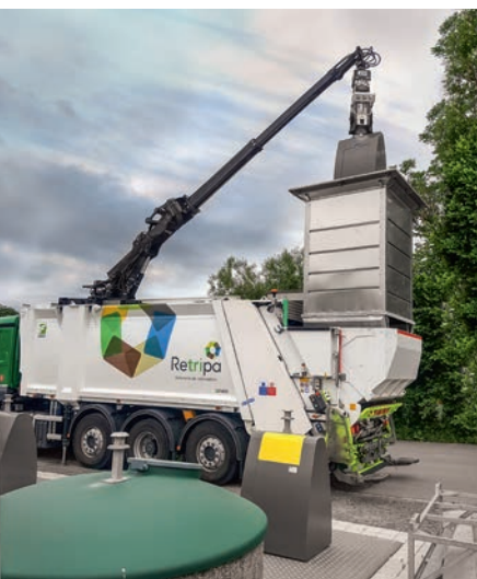
Svuotamento del contenitore mediante gru a tetto con Speed Gripper.
