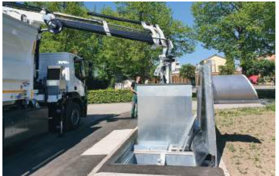
Svuotamento del contenitore d'acciaio da 6 m 3 tramite Speed-Waste-Lifter.
