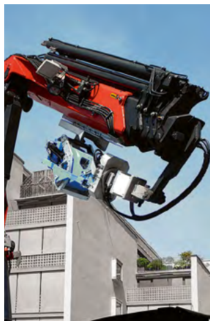
Appareil de levage équipé d'un frein à pendule et d'une balance radio pour grue
