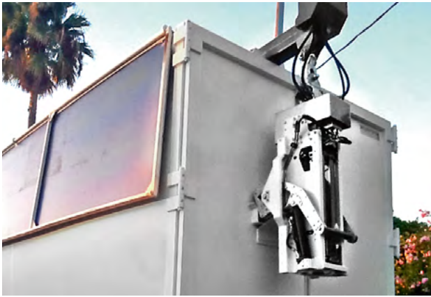
Stationnement de l'appareil à l'arrière, console de stationnement de type VPH 028
