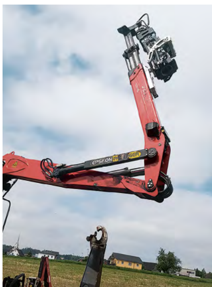
Mettre le bras télescopique en position verticale et le rentrer dans la console
