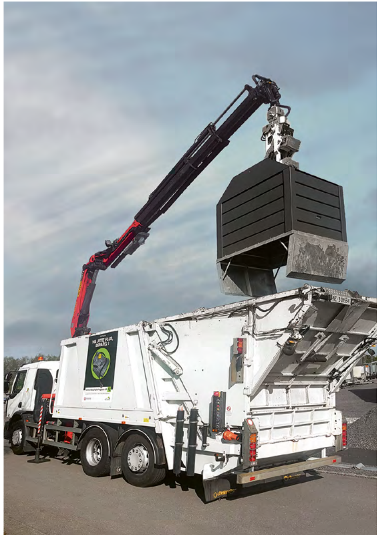
Speed-Gripper équipée d'un dispositif de rabattement modifié, type VP 128
