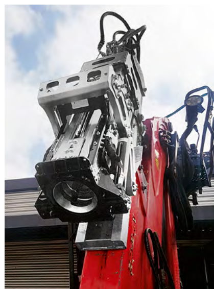
L'appareil est ancré, la grue est repliée
