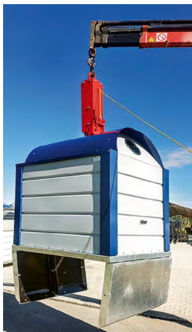
Déplacement du conteneur avec un fond déverrouillé.
