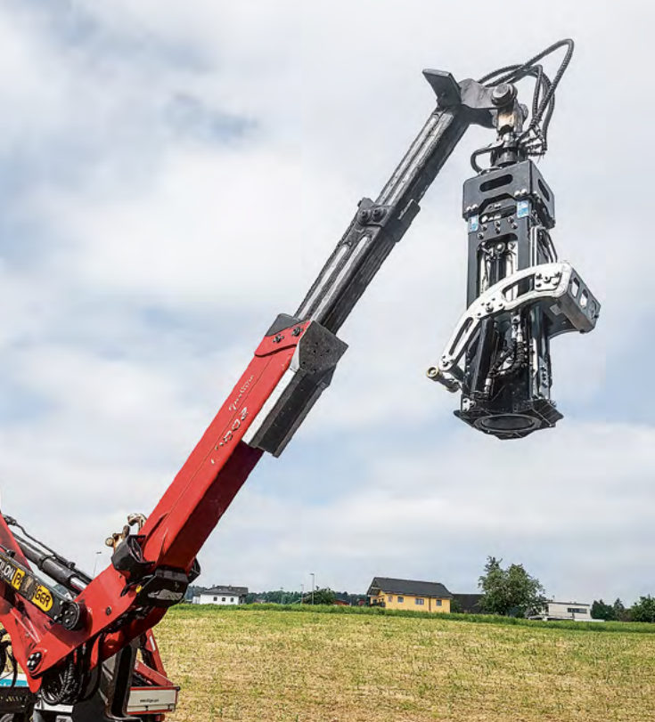
Grue de chargement Z avec dispositif de préhension VP 28 et dispositif de bascu- lement de type VPK 128
