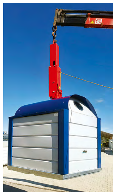
Sollevamento con fondo del container fissato e chiuso.
