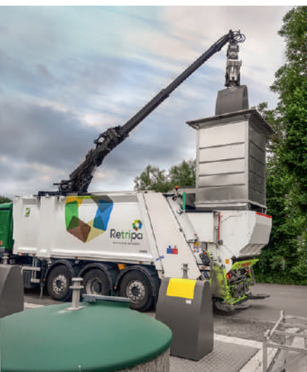
Containerentleerung mittels Dachkran mit Speed-Gripper.
