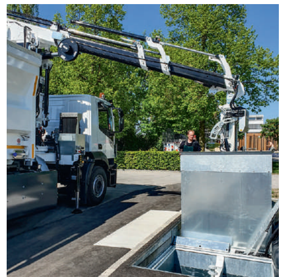
Entleerung des Stahlcontainers mit Inhalt 6 m 3 durch den Speed-Waste-Lifter.
