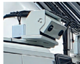
Beidseitig installierte Stereokamera auf LKW-Kabine.
