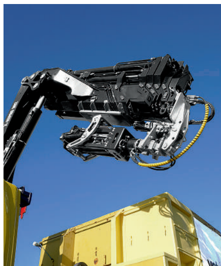
Kran mit Speed-Gripper und Umklappvorrichtung.
