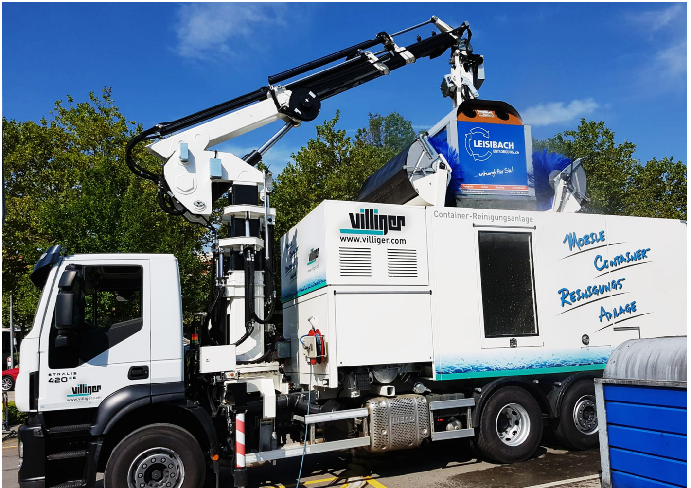
Die mobile Reinigungsanlage bei der Aussen- und Innenreinigung eines Oberflurcontainers.
