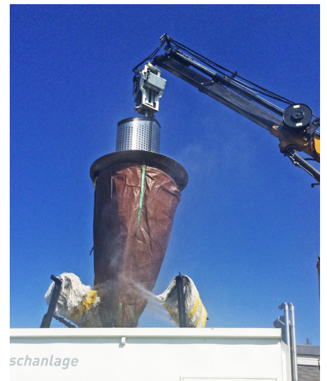
Reinigungsprozess eines Big Bags.
