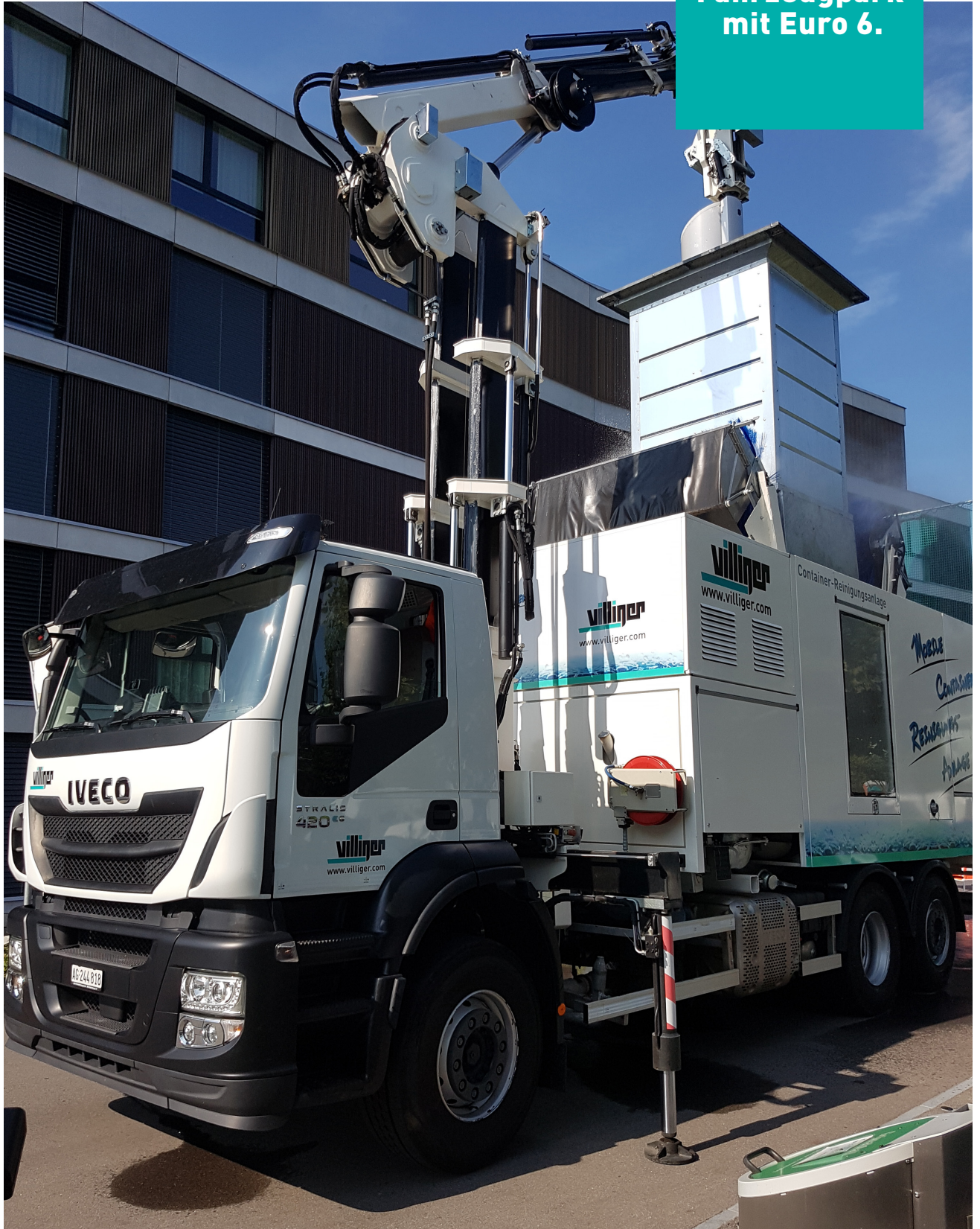
Automatisches Waschen eines Unterflurcontainers in der mobilen Reinigungsanlage. Unterflurcontainer-Reinigung / Frischwassertank (Tankvolumen 3'500 Lt.).
