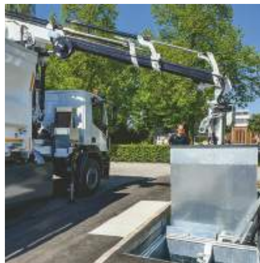
Vidange du conteneur en acier d'une contenance de 6 m 3 par un Speed-Waste-Lifter.
