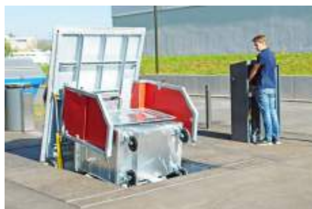
Colonne d'insertion avec pesage des sacs, combinée à trappe de décharge et à un basculeur de conteneurs escamotable.
