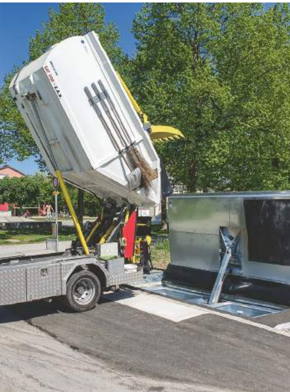
Vidange du conteneur en acier d'une contenance de 6 m 3 par un Speed-Waste-Lifter.
