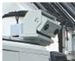
Caméra stéréoscopique installée des deux côtés sur la cabine d'un camion.
