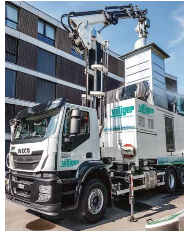
Automatisches Waschen eines Unterflur-Containers in der mobilen Reinigungsanlage.
