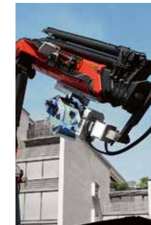
Aufnahmegesetz inklusive Pendelbremse und einer Kran-Funkwaage
