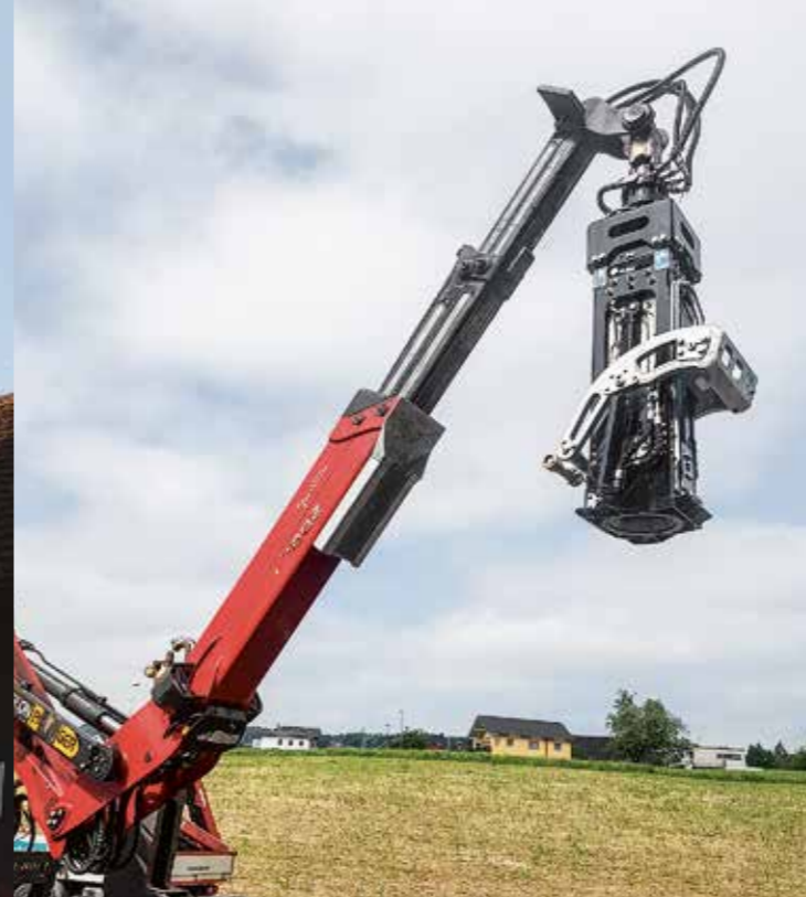
Z-Ladekran mit Aufnahmegesetz VP 28 und der Umklappvorrichtung Typ VPK 128
