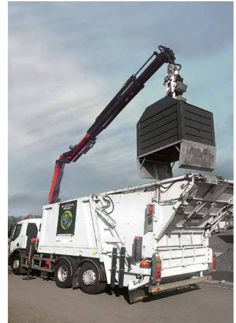
Speed-Gripper mit umgebauter Umklappvorrichtung Typ VP 128
