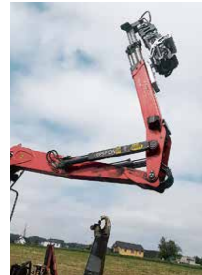
Teleskoparm senkrecht stellen und in die Konsole fahren
