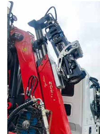
Zusammenfahren des Krans
