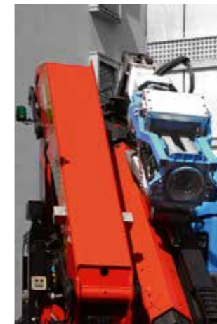
Aufnahmegesetz inklusive Pendelbremse und einer Kran-Funkwaage
