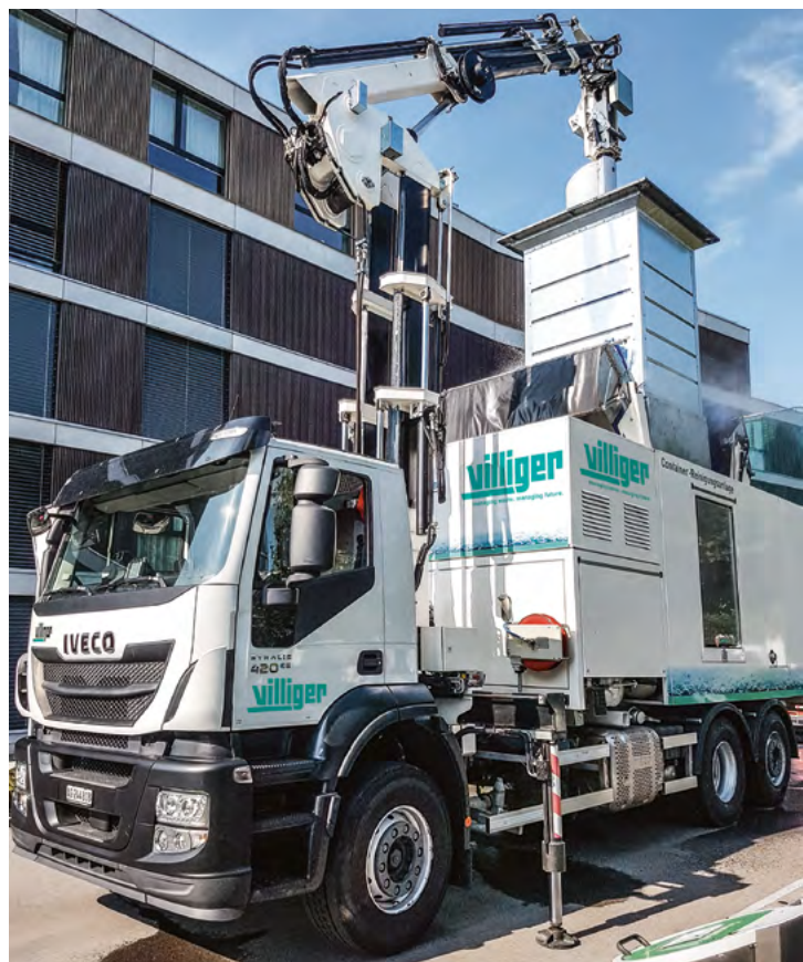
Lavage automatique d'un conteneur enterré dans l'installation de nettoyage mobile.
